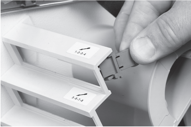
5.1 Kupplungen von hinten in das Patchfeld einrasten.
