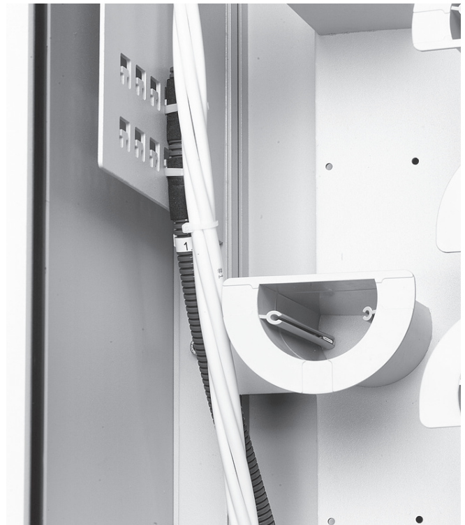
4.3.3 Die IFC-Elemente alle 300mm mit einem Kabelbinder zusammenfassen. Hinweis: Alle Kabelbinder nur handfest anziehen.
