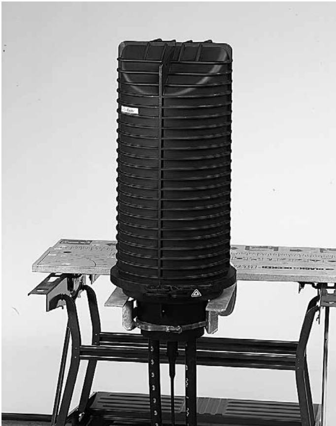
5.7.4 Muffenhaube vorsichtig über die UMS-Profilen führen bis die Haube auf dem Muffenrohr aufsitzt. Markierung am Muffenrohr und Haube zueinander ausrichten.
