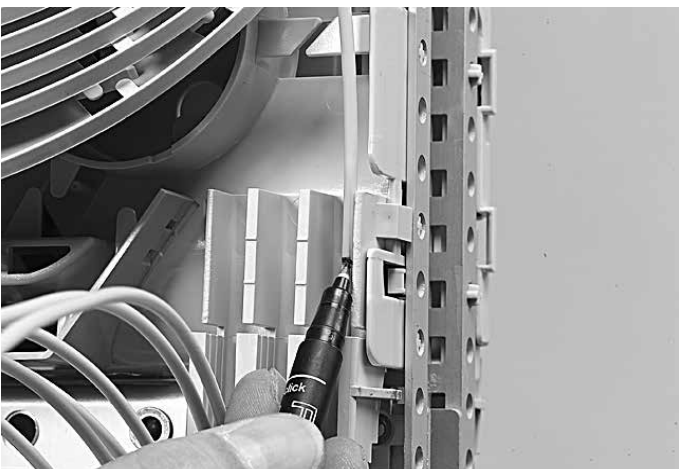
5.5.4.2 Bündeladern in den Halter einlegen und zwischen den Markierungen kennzeichnen.
